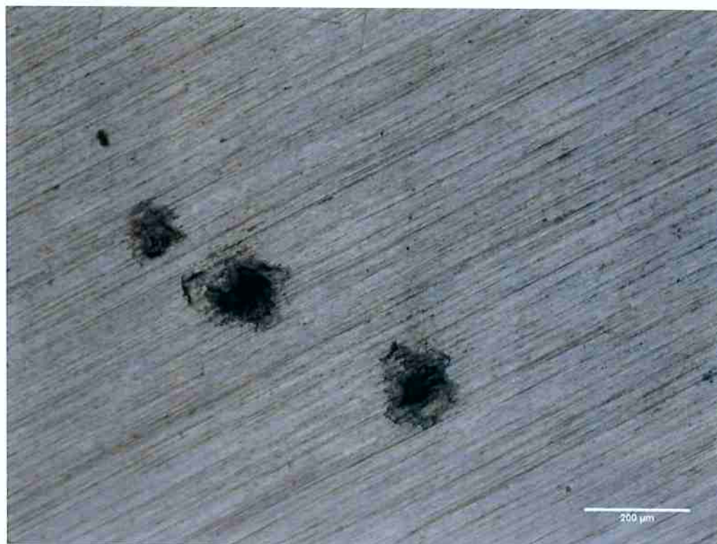
Figura 40. Pites formados após polarização potenciodinâmica cíclica em solução 0,6M NaCl + 0,15 Na 2 SO 4 do aço austenítico 304L visualizados com aumento de 100x. Acabamento superficial: lixa #600. Notam-se pites sem escoamento do eletrólito no interior dos pites formados.
