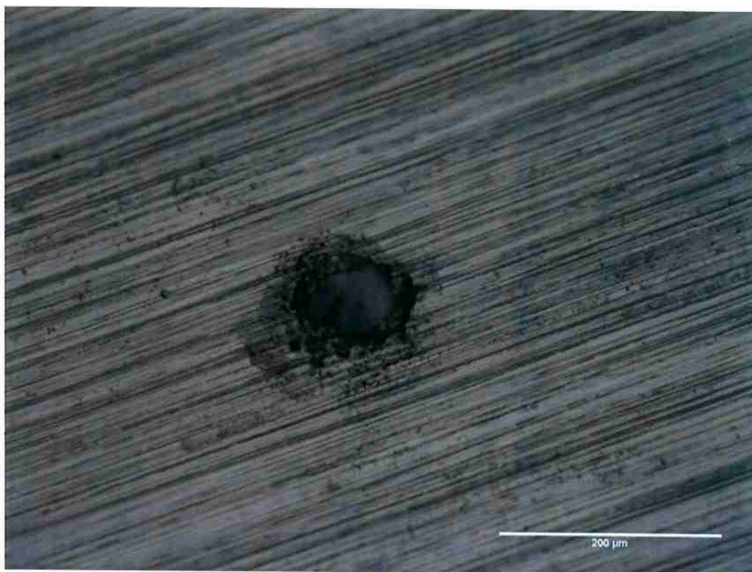
Figura 41. Pites formados após polarização potenciodinâmica cíclica em solução 0,6M NaCl + 0,15 Na 2 SO 4 do aço austenítico 304L visualizados com aumento de 200x. Acabamento superficial: lixa #600. Notam-se pites sem escoamento do eletrólito no interior dos pites formados.
