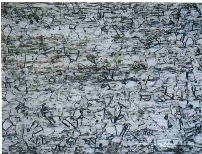
Figura 12. Microestrutura do aço 304L na condição tal como recebido resultante da prática A. Seção transversal da chapa. Aumento de 200x no microscópio óptico.
