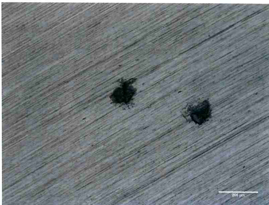
Figura 39. Pites formados após polarização potenciodinâmica cíclica em solução 0,6M NaCl + 0,15 Na 2 SO 4 do aço austenítico 304L visualizados com aumento de 100x. Acabamento superficial: lixa #600. Notam-se pites sem escoamento do eletrólito no interior dos pites formados.
