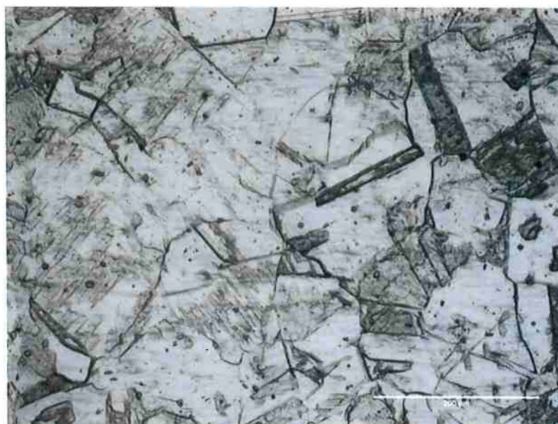
Figura 14. Microestrutura do aço 304L na condição de tratamento de solubilização em 1100°C resultante da prática A. Aumento de 200x no microscópio óptico.
