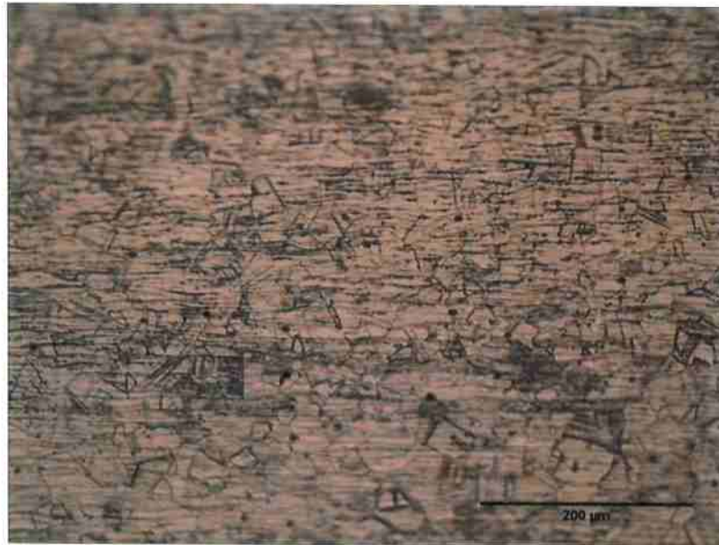
Figura 9. Microestrutura do aço 298 na condição tal como recebido resultante da prática A. Seção transversal da chapa. Aumento de 200x no microscópio óptico.
